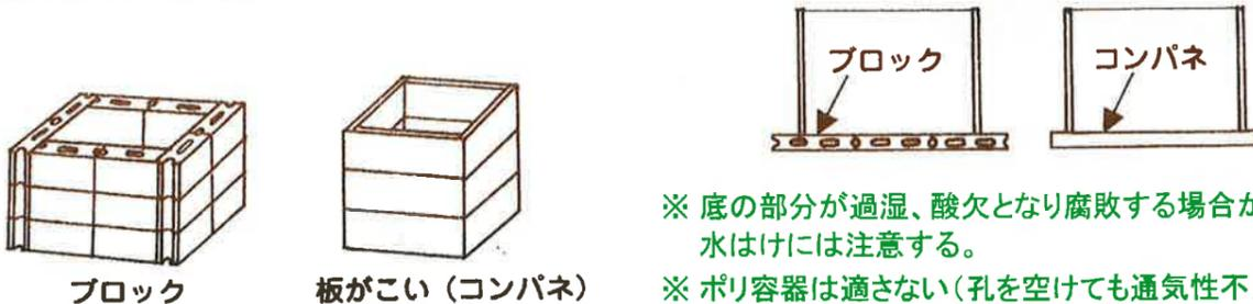
※ 底の部分が過湿、酸欠となり腐敗するが多い。水はけには注意する。
